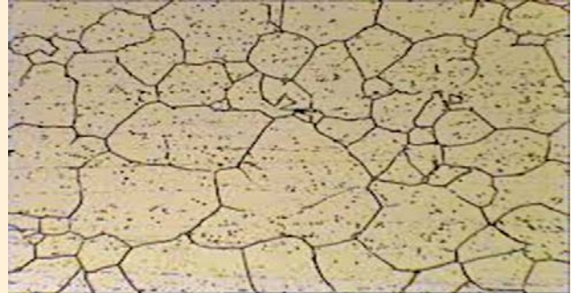
شکل (۱۱) ساختار میکروسکوپی نمونه فولاد (uni 663 grade Fe ۴۵-۲) در دمای بالا
