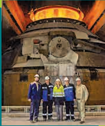
تصویر-۴: بزرگترین کنورتور اکسیژنی دنیا (۴۰۰ تنی) مستقر در شرکت تیسن کروپ آلمان
